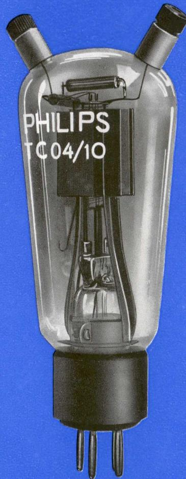
Le tube peut ainsi fonctionner comme oscillateur sur des longueurs d'ondes descendant jusqu'à 4 m, la tension anodique peut dans ce cas atteindre 250 V.
